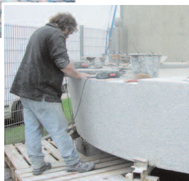
Oberflächen- bearbeitung im Lübecker Werk.
